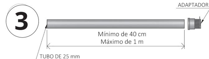
Insira o tubo com adaptador no interior do cano 50mm e rosqueie no corpo dispositivo hidromassagem.
