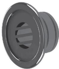
Fabricado com aço inox 316, o dispositivo de aspiração Industek foi pensado e moldado para trazer rápido escoamento e nivelamento. Com diâmetro para encaixe em PVC marrom de 50mm, e uma boa vazão, impede o transbordamento de sua piscina em dias chuvosos.
