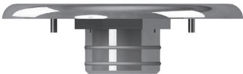
Fabricado com aço inox 316, o dreno de fundo Industek foi pensado e moldado para trazer discrição e funcionalidade para o seu sistema de sucção. Com diâmetros de 50mm e 60mm e vazões de 9m<sup>3</sup>/h e 13m<sup>3</sup>/h, respectivamente, permitem fluidez e segurança na sucção até a bomba. O produto, ainda, propõe praticidade na instalação, podendo fazê-la diretamente no tubo de PVC marrom, apenas encaixando.
